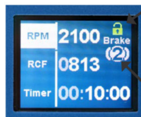
Das Schloss zeigt den aktuellen Zustand der Deckelverriegelung an: grün - geöffnet rot - geschlossen
