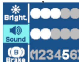
Display für: Anzeigehelligkeit, Lautstärke des Pieptons, Bremsstufen
